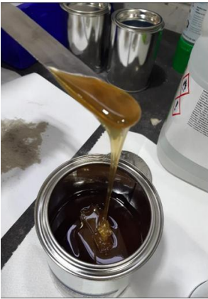
Abbildung 4: von Fremdstoffen gereinigtes Rezyklat-Polyol
