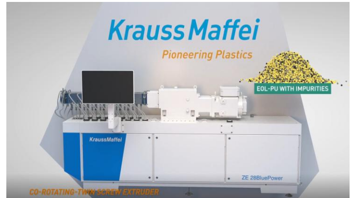
Abbildung 3: gleichläufiger Doppelschneckenextruder als Verfahrensraum für die Depolymerisation
