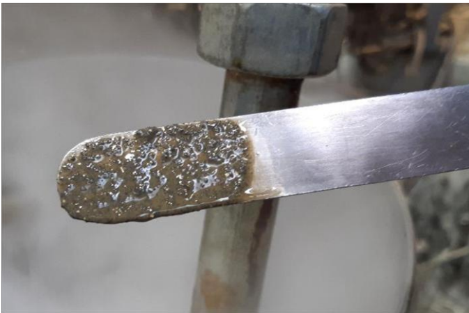
Abbildung 2: Mit Fremdstoffen verunreinigtes Rezyklat-Polyol
