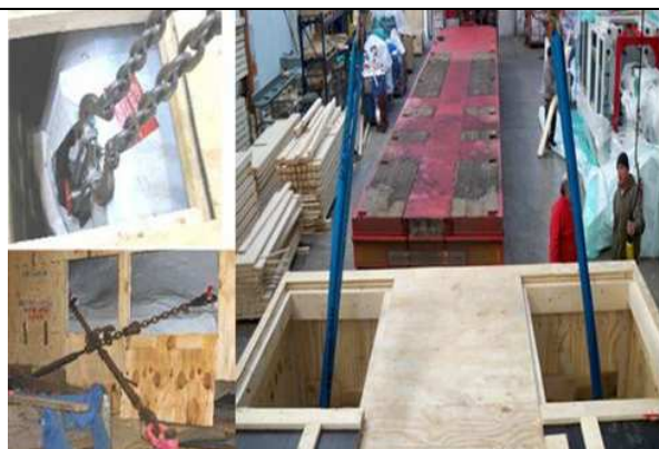
木箱只是附带包装 - 吊挂点在机器上！ / 重要： 务必将薄膜和木箱上的翻板重新封住！
