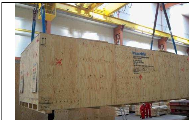
木箱只是附带包装 - 吊挂点在机器上！ / 重要： 务必将薄膜和木箱上的翻板重新封住！
