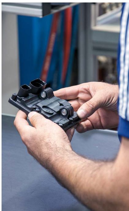
Oben links und rechts: Diese Gehäuse für die Getriebe- steuerung aus PA/LSR mit Metalleinlegern und aufgeschweißter Membran wird in einem vollautomatischen Prozess hergestellt.
