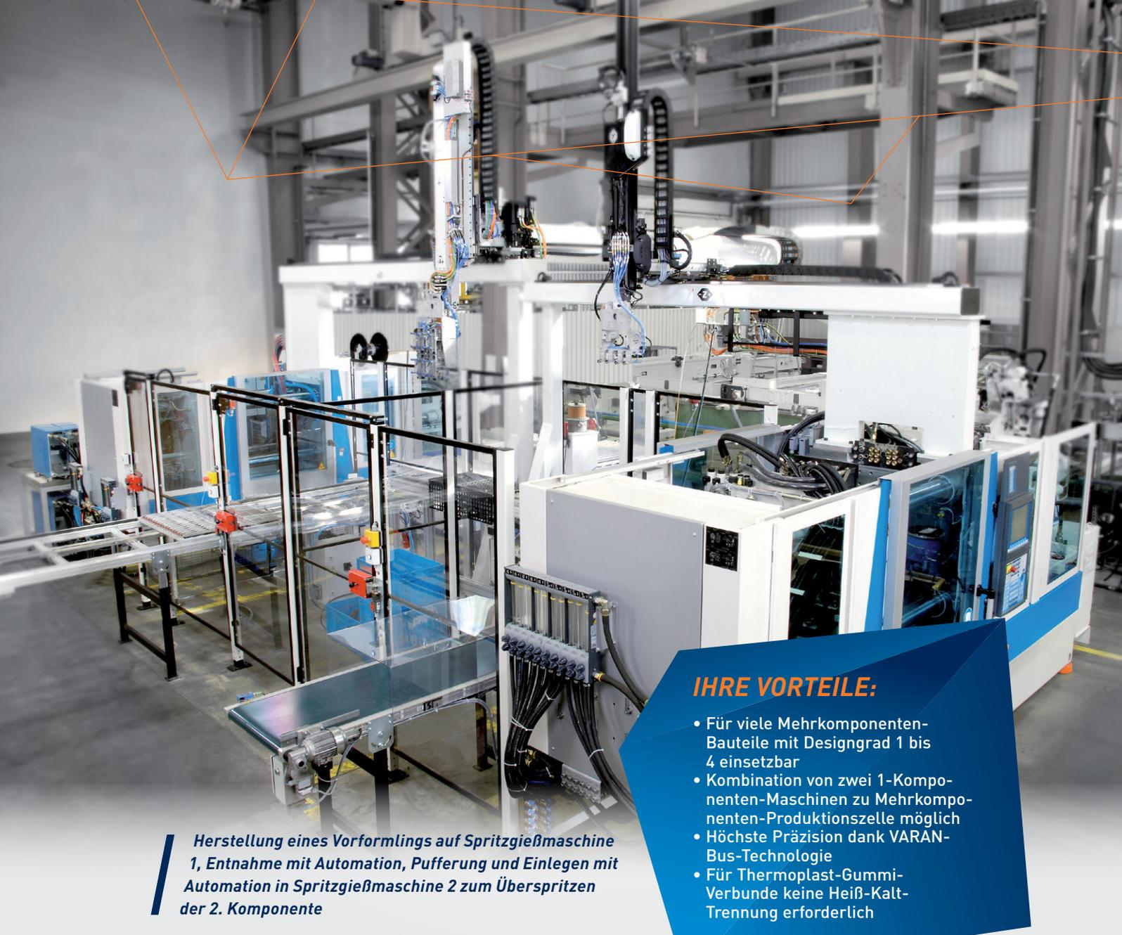
**Herstellung eines Vorformlings auf Spritzgießmaschine 1, Entnahme mit Automation, Pufferung und Einlegen mit Automation in Spritzgießmaschine 2 zum Überspritzen der 2. Komponente**
